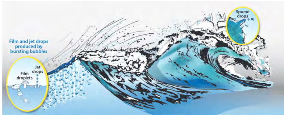
FIGURE 1.6 – Schéma illustrant les principaux mécanismes de génération des embruns : par éclatement de bulles expulsant des gouttelettes à la surface ou par éjection de la crête (lorsque le vent est suffisamment important). Figure extraite de Veron, 2015.
